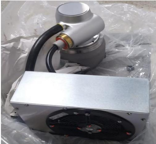
**Ensamble del Tubo del tomógrafo**
